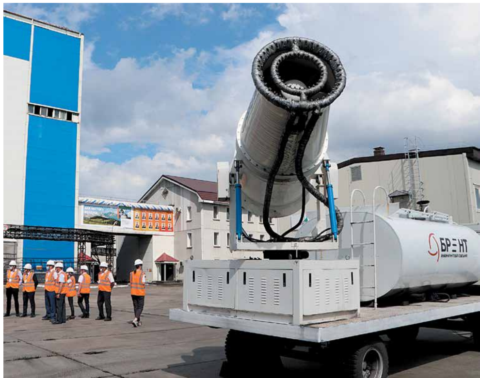
В преддверии Дня шахтера на ОФ «Распадская» запустили в работу две установки пылеподавления
